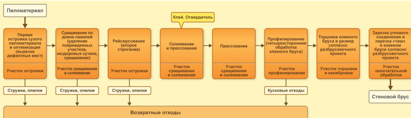
Схема технологического процесса производства стенового бруса
